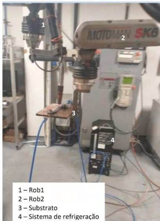
Figura 3: Detalhe do sistema de refrigeração na placa base.
