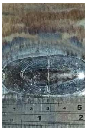
Figura 15. Aspecto exterior del cordón de soldadura - Prueba 2
