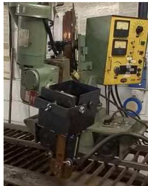
Figura 3. Cabezal de soldadura adaptado a la unidad de control CAS-100.
