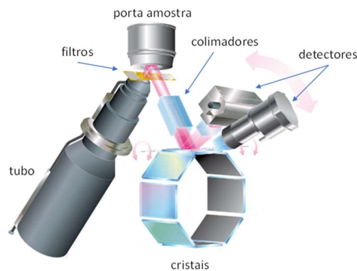
Figura 5: Esquema de um espectrômetro de Florescência de Raios-X dispersivo em comprimento de onda. Adaptado de [30]
