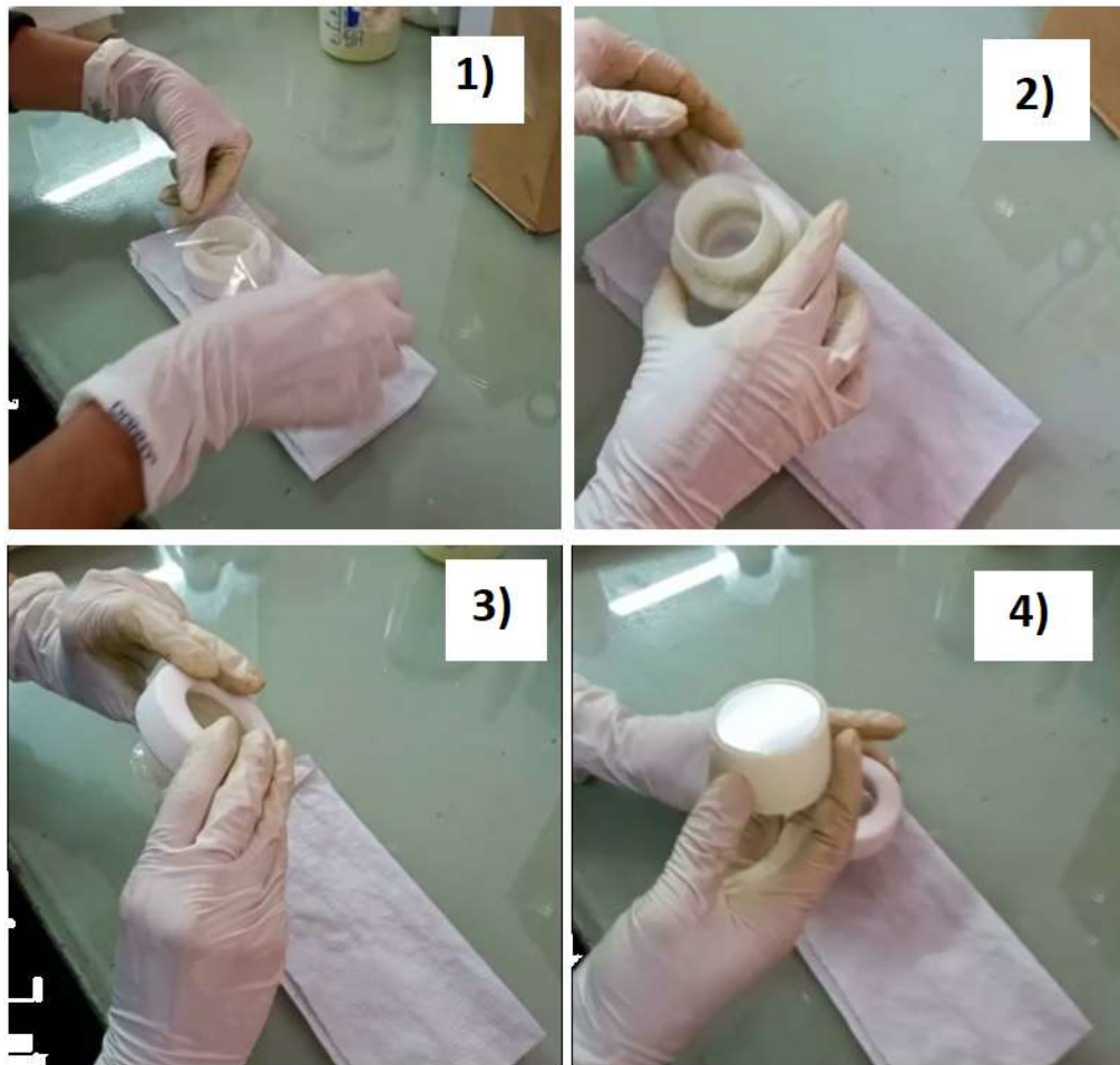
Figura 31: Etapas para montagem de uma cubeta para análise de soluções. 1) colocação do filme plástico; 2) Posicionamento da peça externa; 3) encaixe das peças; 4) Cubeta montada.
