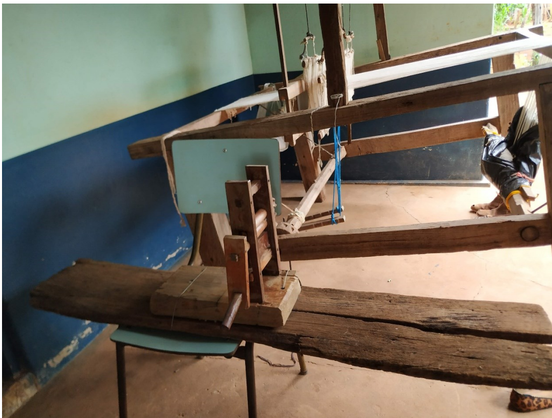
Figura 5 - "Escaroçador" e tear ao fundo.
