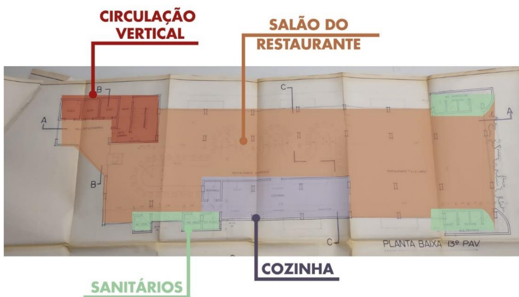
Figura 225 - Pavimento cobertura com salão para restaurante.
