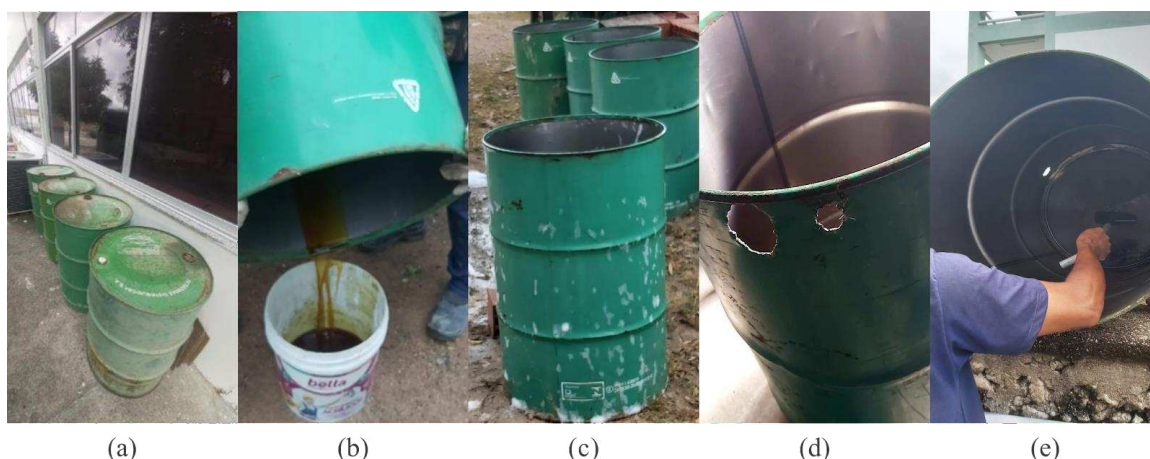
Figura 3. Construção do sistema de armazenamento: (a) recuperação dos tonéis (b) remoção de fluidos residuais, (c) limpeza, (d) perfuração e (e) pintura dos tonéis.
