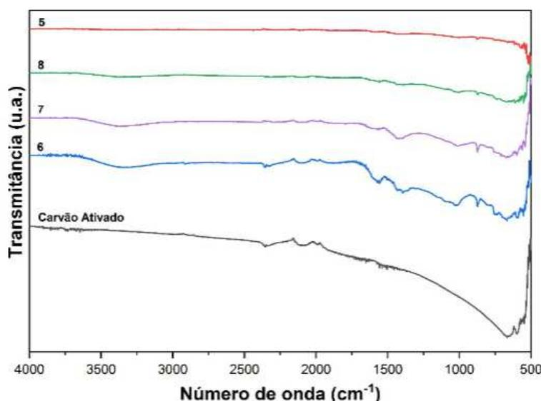
Figura 4: Espectros de FTIR alguns carvões obtidos na pirólise e do carvão ativado
