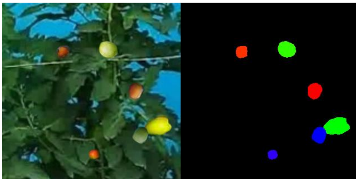
Figura 5- Exemplo de imagens do banco sintético com imagens com a extensão png sobre o background (A) e sua respectiva máscara (B) obtida pela biblioteca cocosynth
