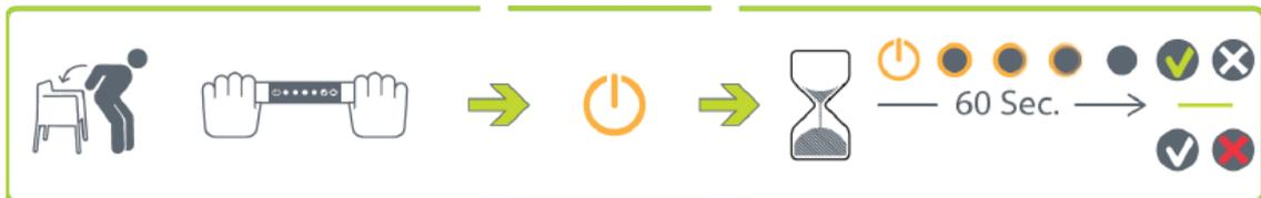
**Figura 2** - Ilustração do funcionamento do dispositivo (*MyDiagnostick*<sup>®</sup> 1001R - Device Manual)<sup>55</sup>.
