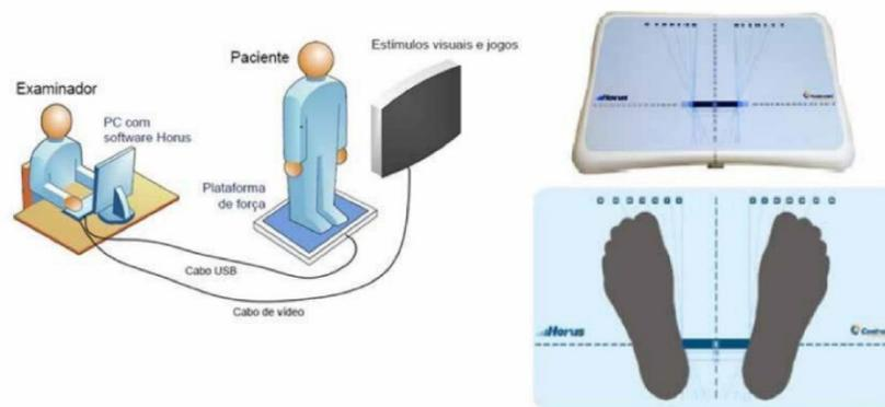
**Figura 2.** Ilustração esquemática do diagrama funcional e posicionamento do pé da plataforma de força Horus® (FERREIRA et al., 2020b).
