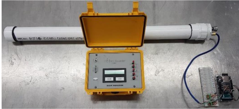
Figura 19 – Imagem representando os componentes utilizados nos testes feitos por Sattler et al. (2020) - Câmara de pressão, unidade de leitura comercial e registrador de dados de baixo custo que foi elaborado
