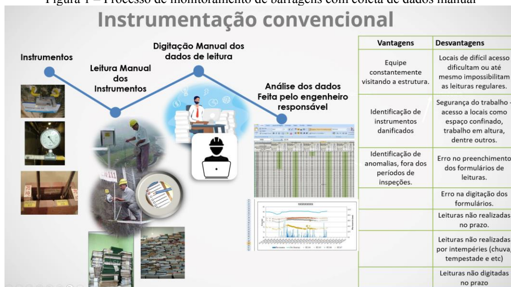
Figura 1 – Processo de monitoramento de barragens com coleta de dados manual
