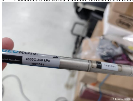
Figura 107 – Piezômetro de corda vibrante utilizado em todos os testes
