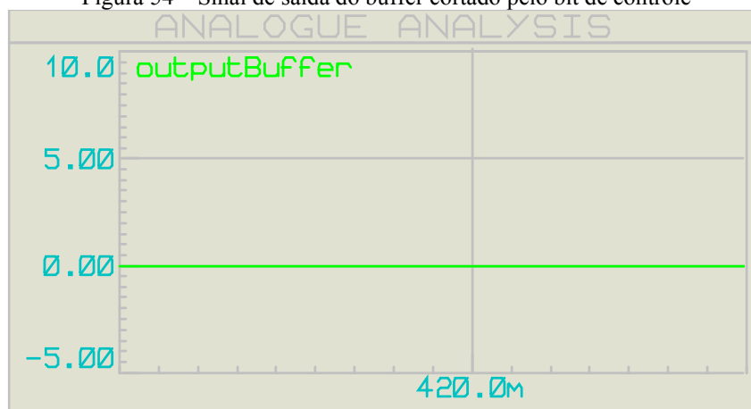
Figura 54 – Sinal de saída do buffer cortado pelo bit de controle
