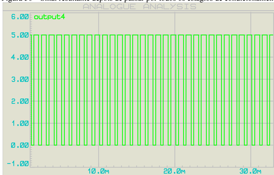
Figura 50 – Sinal resultante depois de passar por todos os estágios de condicionamento
