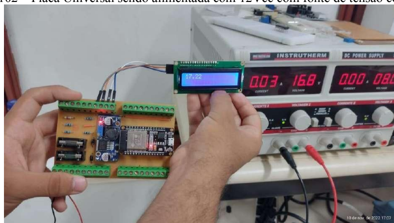
Figura 102 – Placa Universal sendo alimentada com 12Vcc com fonte de tensão controlada
