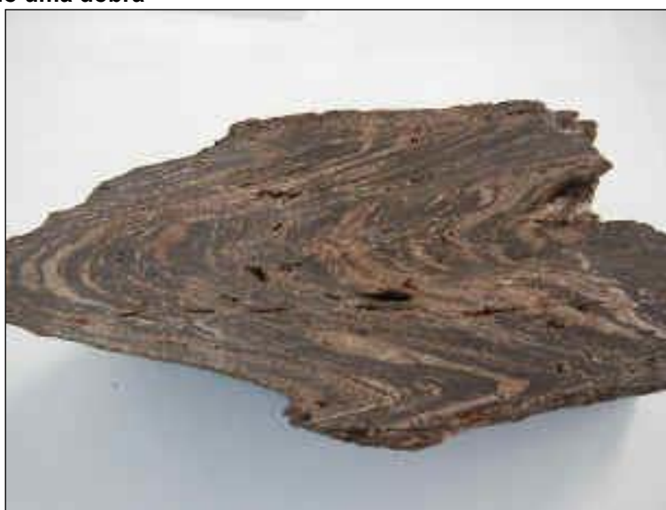
Figura 2 - Itabirito com domínios ricos em quartzo (parte clara) intercalado com níveis ricos em hematita configurando uma dobra
