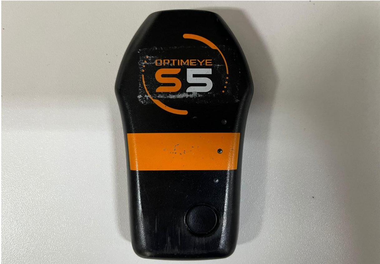
**Figura 3.** Sistema de posicionamento global (*Catapult OptimEye S5*).
