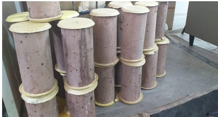
Figura 13 – Concepção de Corpos de Prova de Concreto e Rejeito.
