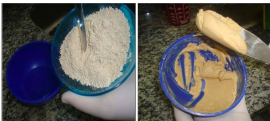
Figura 37 – Manipulação de gesso
