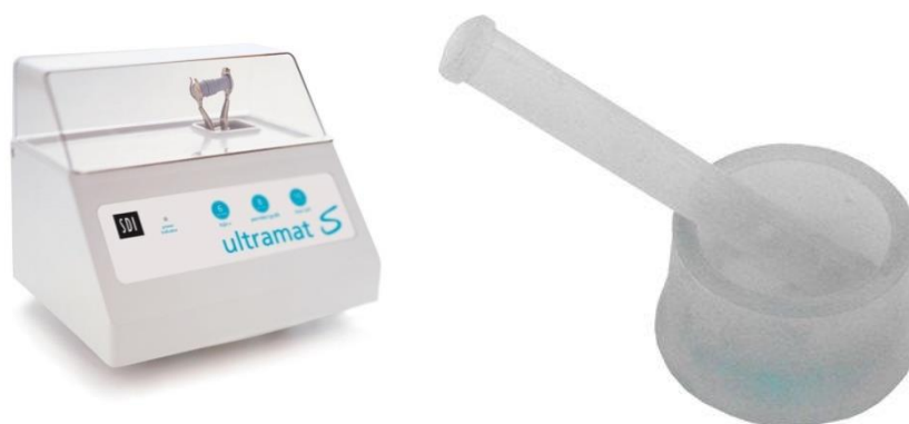
Figura 13 – Amalgamador digital. Gral e pistilo para amalgamação manual
