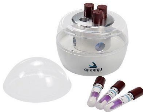
Figura 26 – Mini incubadora e ampola do teste biológico
