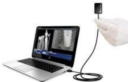
Figura 14 – Receptor digital para raio x odontológico.
