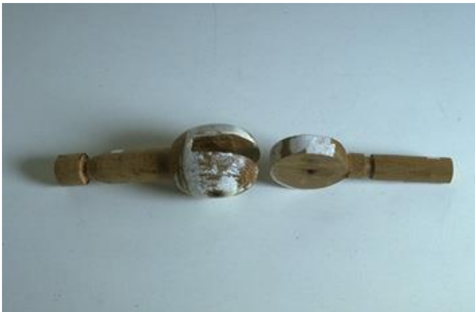
FIG.17- Peças que compõem a articulação Esfera Macho/Fêmea
