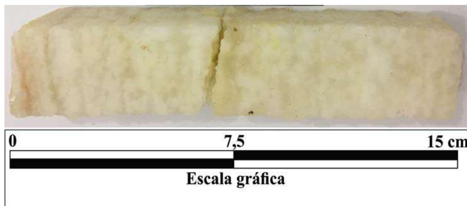
Figura 6 – Amostra do Intervalo Mineralizado Inferior na porção nordeste do Depósito de Autazes: silvinita branca leitosa, opaca, nodular. Furo 35, profundidades: 770,16 m a 770,31 m (modificado de Potássio do Brasil, 2014).
