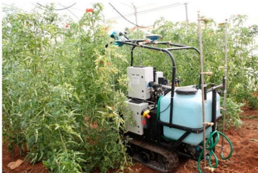
Figura 4 Veículo de pulverização equipado com sistema inteligente para o acesso de culturas que são difíceis a operação de pulverização. Fonte: Cantelli *et al.*, 2019.
