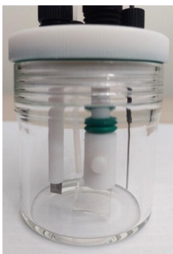
Figura 30 -Fotografia do sistema potenciostático de três eletrodos. Fonte: Autoria própria
