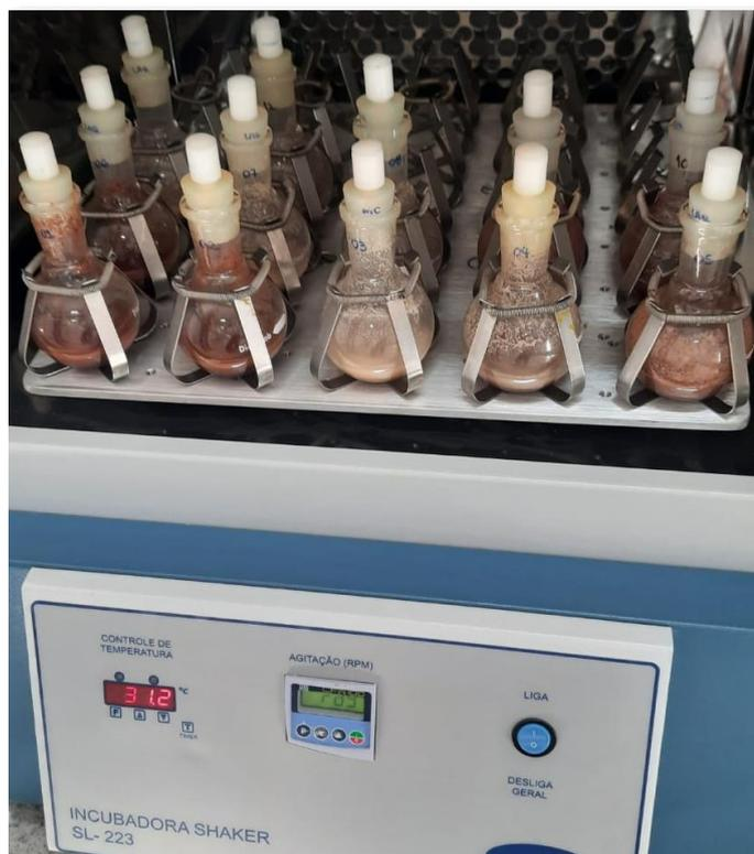
Figura 6. Balões fechados com rolhas de silicone acopladas a *airlocks* em incubadora *shaker* preparados para o processo de sacarificação e fermentação simultâneas.
