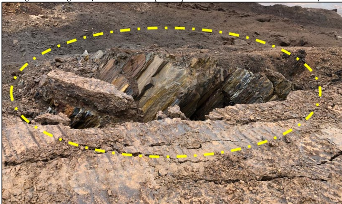
Figura 12 - Fragmentação de desmorte impactada pelo backbreak em zona de alta estratificação
