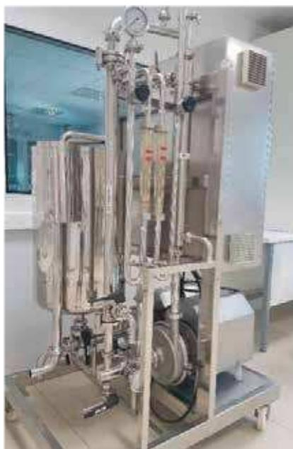
Figura 31: Biorreator de 120L
