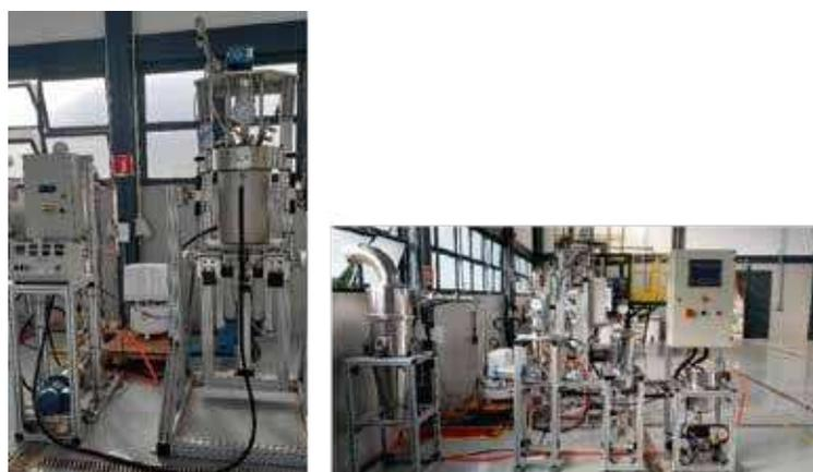
Figura 30: Reatores de alta pressão.
