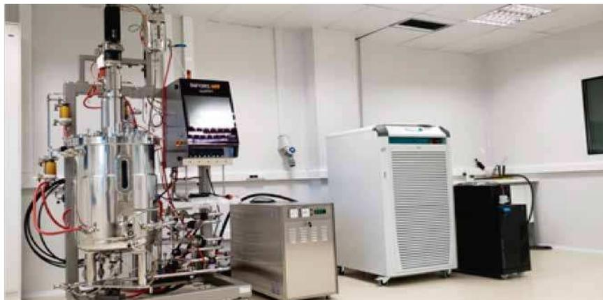
Figura 31: Biorreator de 120L
