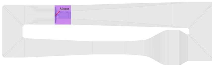
Figura 6 - Domínio rotativo via MRF, relativo à região do motor. Fonte: Elaborado pelo autor.
