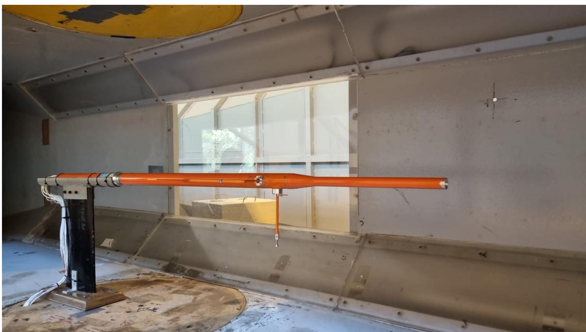
Figura 61 - Tubo de pitot cedido pela empresa AERON e utilizado no ensaio. Fonte: Cedido pelo Laboratório de Aerodinâmica da UFMG.
