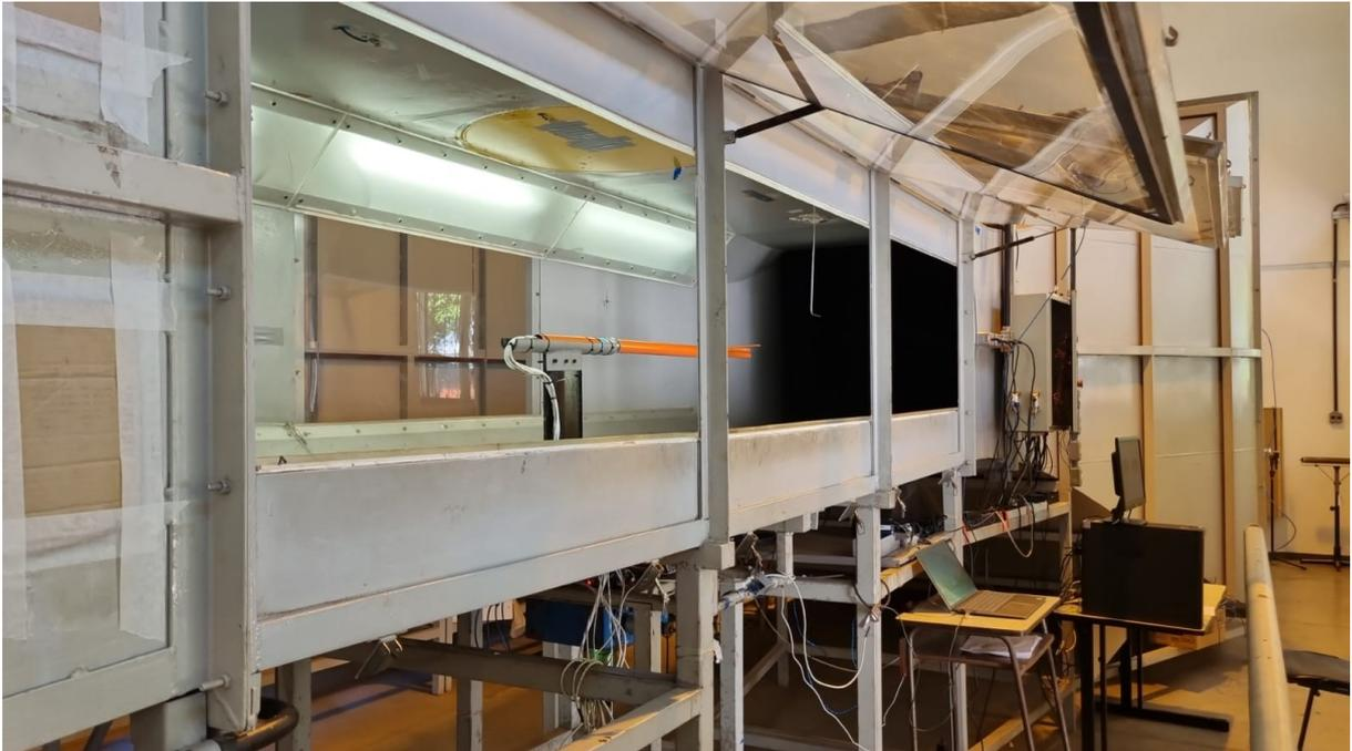
Figura 62 - Posicionamento do tubo de pitot cedido pela empresa AERON na seção de teste. Fonte: Cedido pelo Laboratório de Aerodinâmica da UFMG
