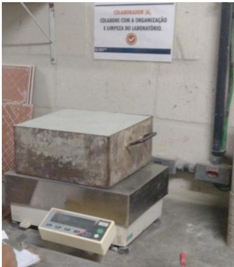
Figura 55 - Mostra a pesagem da areia para realização do ensaio de granulometria.
