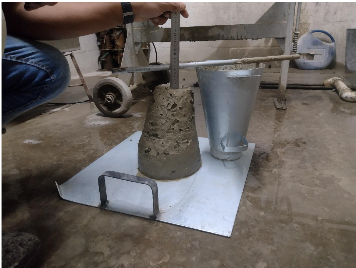
Figura 52 - Mostra o ensaio de determinação da consistência pelo abatimento do tronco de cone.
