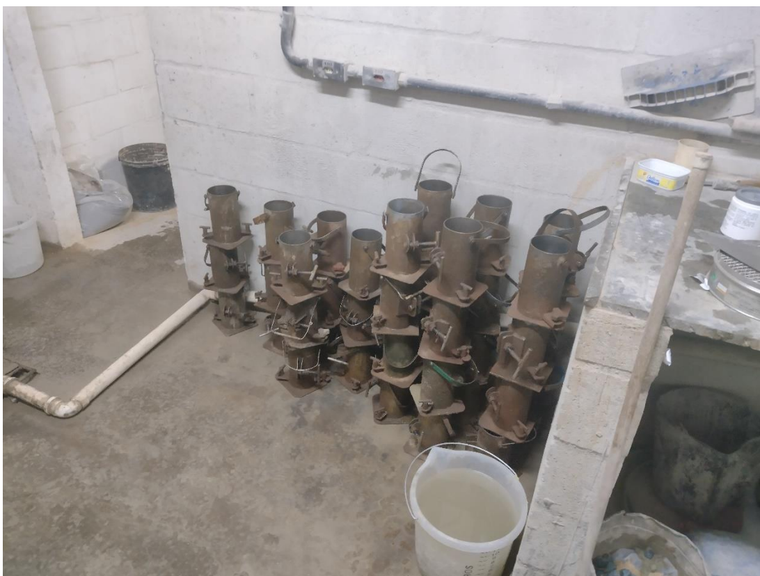
Figura 50 - Mostra as formas dos corpos de prova.
