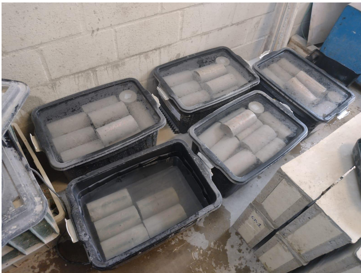
Figura 61 - Mostra os corpos de prova durante a cura úmida.
