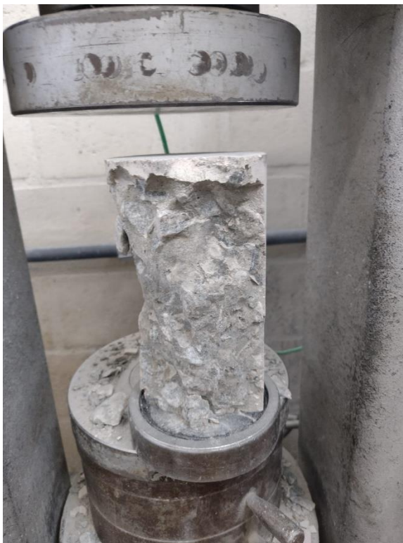
Figura 79 - Mostra o corpo de prova CP 95 rompido aos 273 dias.
