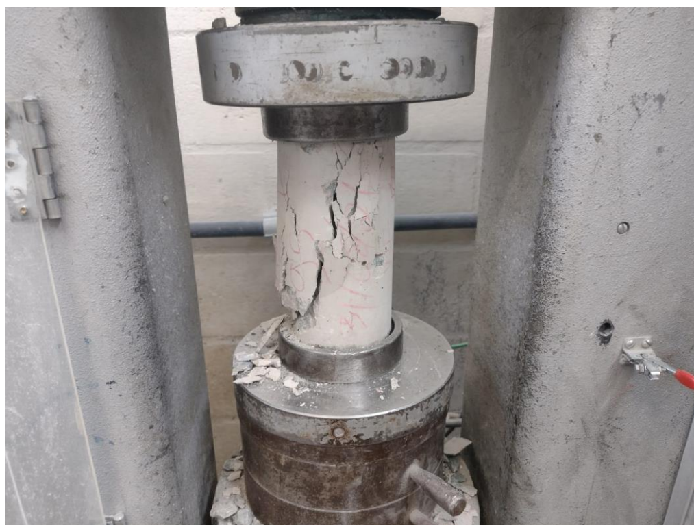
Figura 80 - Mostra outro corpo de prova CP 95 rompido aos 273 dias.
