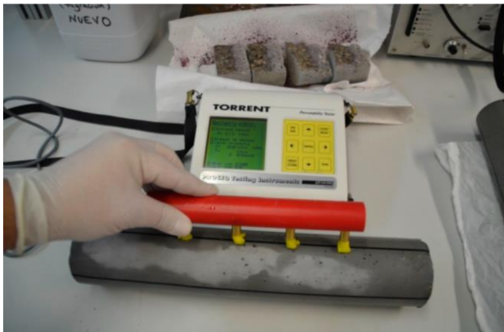
Figura 30 - Medição de resistividade elétrica de uma amostra de sílica ativa a 10% feita usando o método de quatro eletrodos “Wenner”.
