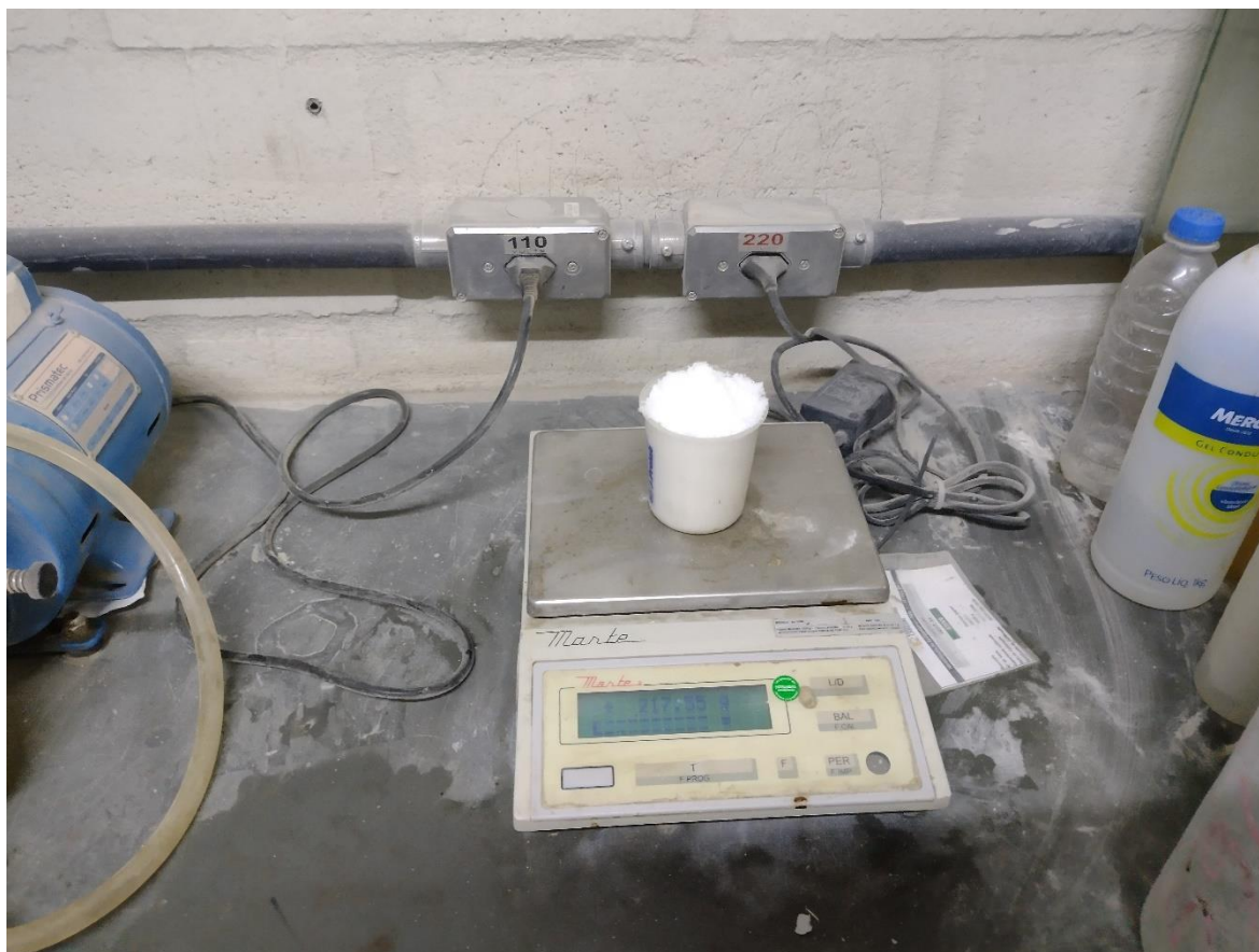
Figura 60 - Mostra a pesagem do sulfato de magnésio.
