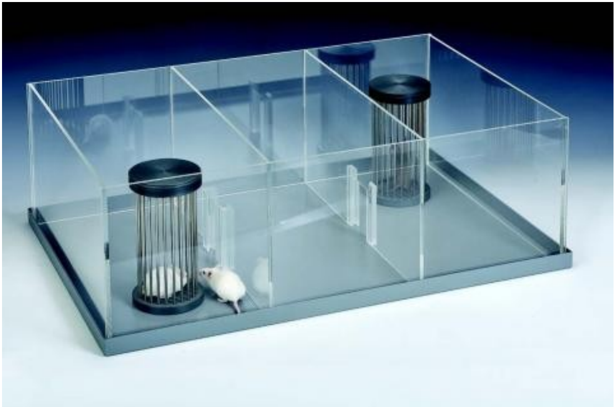
Figura 18 - Aparato do Teste de Reconhecimento Social de Três Câmaras. Adaptada de (Social Behavior | Neural Circuits and Behavior Core, [s.d.]).
