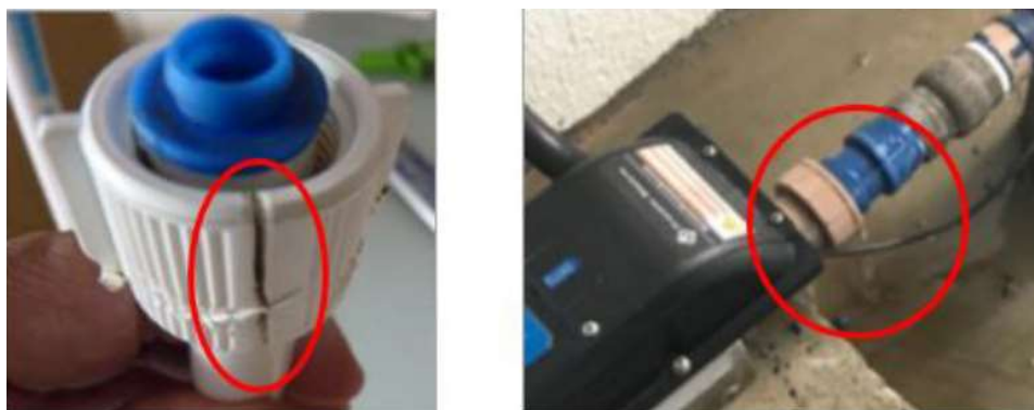
Figura 43 – Exemplos de observação de ruptura em luvas de acoplamento
