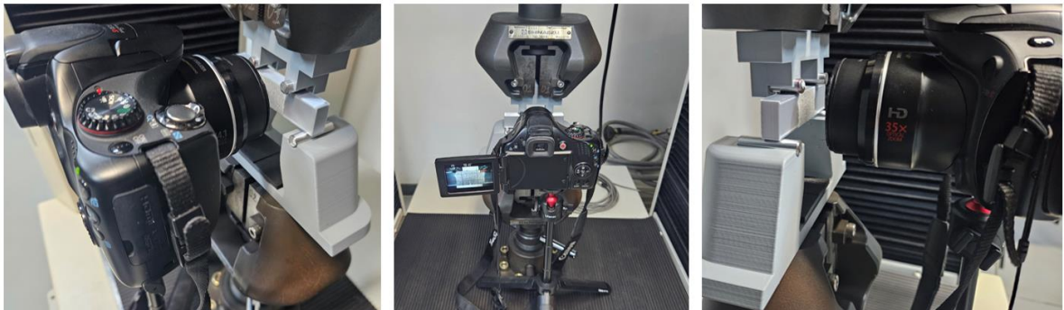
Figura 3.12- Montagem do teste para captação de imagens 2D - CID
