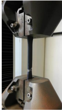
Figura 3.7- Posicionamento do corpo de prova no ensaio de tração.
