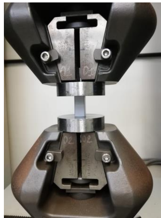
Figura 3.8- Posicionamento do corpo de prova no ensaio de compressão.
