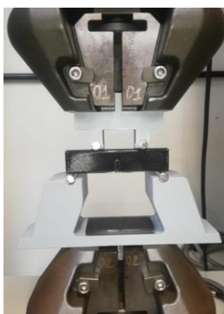
Figura 3.9- Posicionamento do corpo de prova no ensaio de flexão em quatro pontos.
