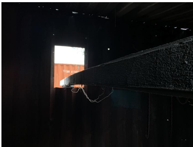
Figura 5-26 – Deformada da viga V1-TQ100x4,75 após ensaio
