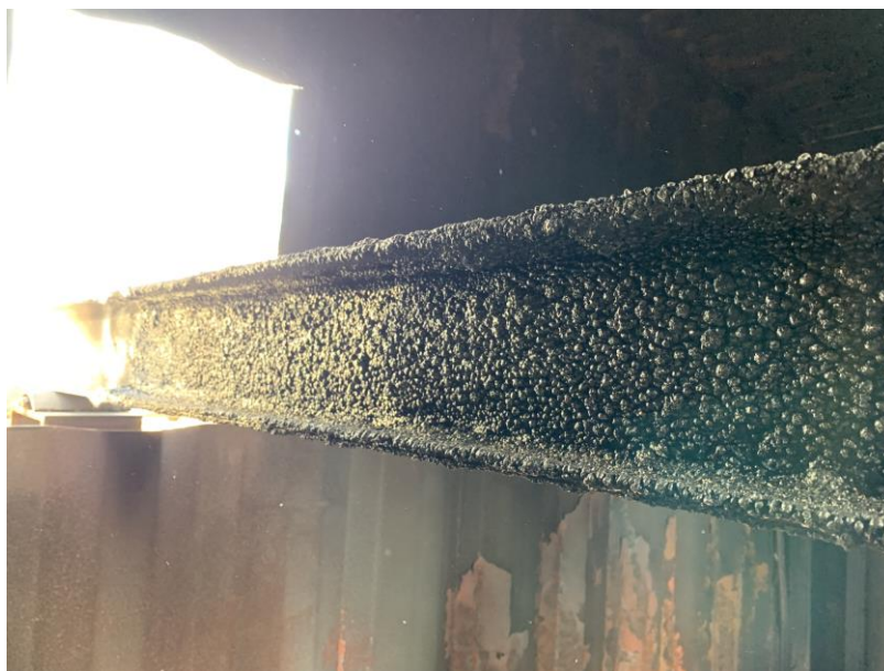
Figura 5-27 - Deformada da viga V2-W150X13 após ensaio
