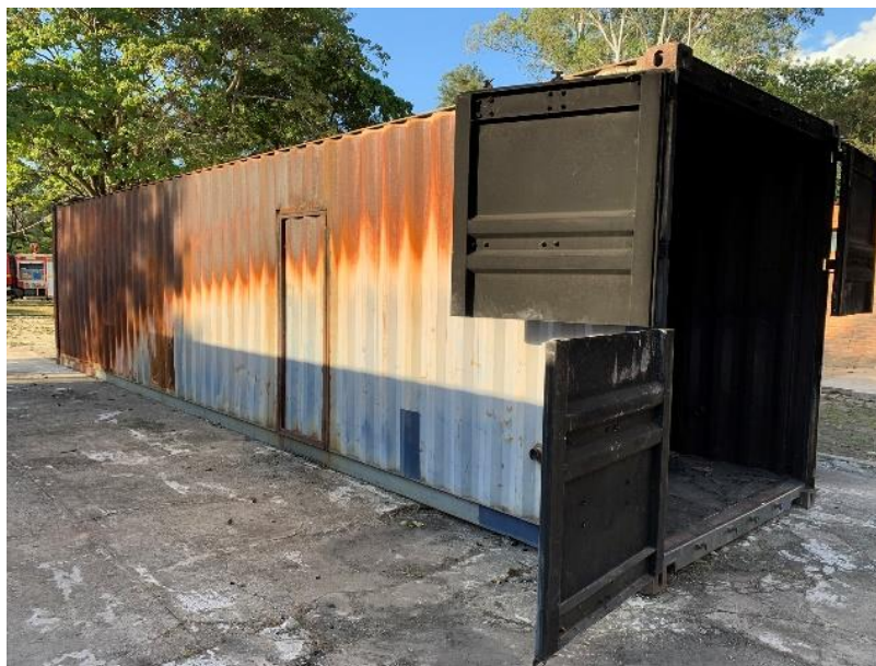
Figura 5-1- Container metálico utilizado nos ensaios de resistência ao fogo de vigas protegidas.
