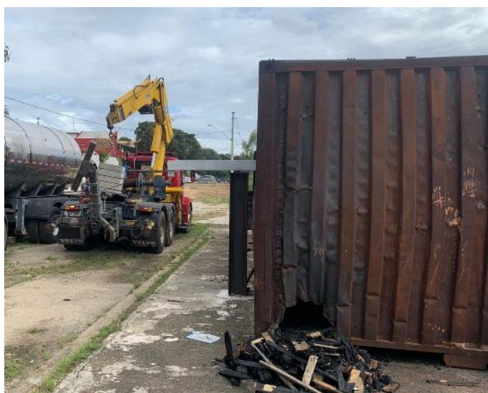
Figura 5-5- Montagem do set-up de ensaio com auxílio de caminhão Munck.
