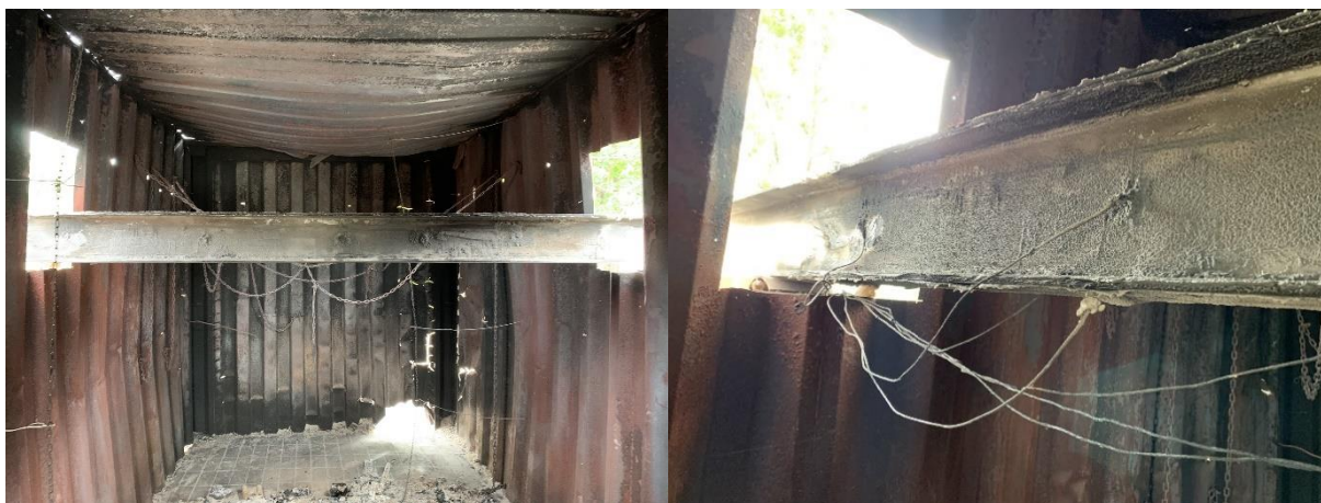
(a) (b) Figura 5-21 - Expansão da tinta intumescente na viga V3-W200X31,3
