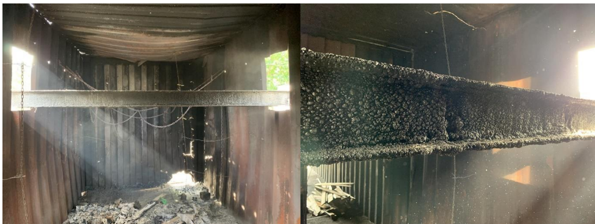
(a) (b) Figura 5-20 - Expansão da tinta intumescente na viga V2-W150X13
