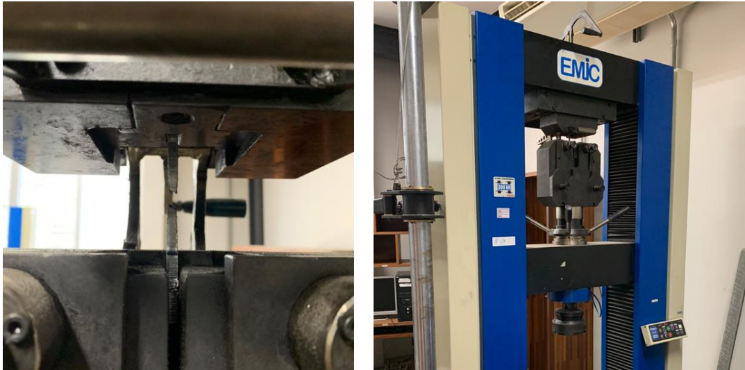
Figura 3-3 – Aparelho de ensaio a tração a temperatura ambiente
