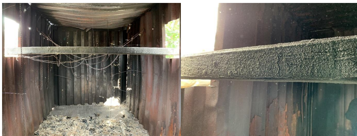
(a) (b) Figura 5-19 - Expansão da tinta intumescente na viga V1-TQ100X4,75.
