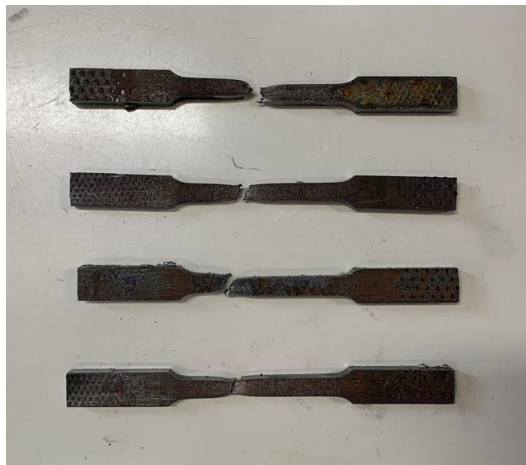
Figura 3-4 - Amostras após ensaio de tração e o perfil de ruptura registrado
