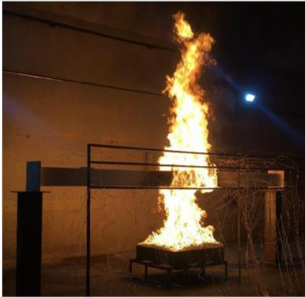
(a) Viga submetida ao incêndio localizado
