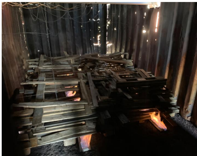
Figura 5-6- Carga de incêndio posicionada para início do ensaio.
