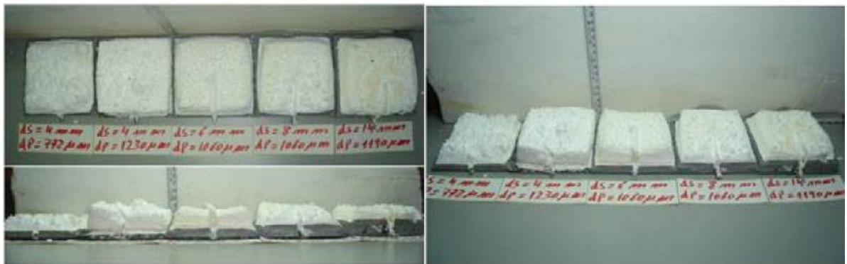
(b) Evolução do processo expansivo nos ensaios de placas em fornos de resistência ao fogo.
