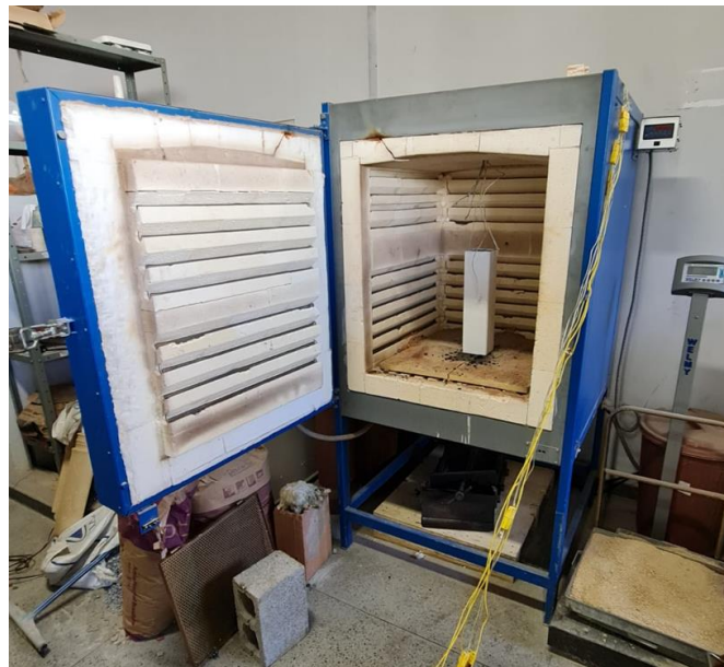
Figura 4-1- Forno elétrico utilizado nos ensaios de reação ao fogo.
