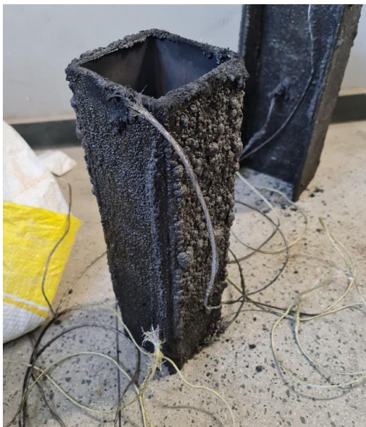
Figura 4-24 - Trinca na camada expansiva da tinta intumescente
