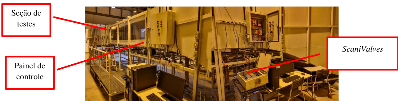
Figura 14 - (a) seção de testes com o painel do sistema de controle de velocidade; (b) painel de controle de velocidade aberto e transdutores ScaniValves para aquisição de pressões
