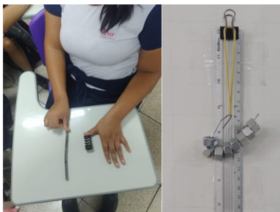
Figura 1: Aspecto sensorial de uma mola e experimento da deformação de um elástico.
