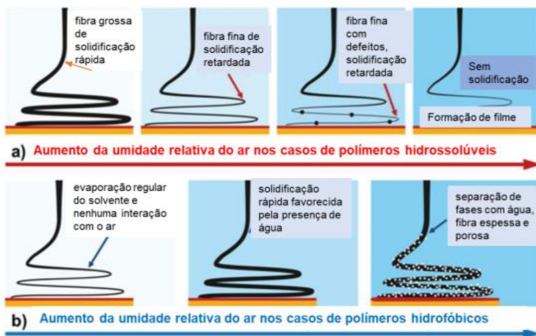
Figura 3.11 Representação do efeito da umidade relativa do ar no diâmetro da fibra: a) para polímeros hidrossolúveis, b) para polímeros hidrofóbicos. Adaptado de MAILLEY; HÉBRAUD; SCHLATTER, (2021)
