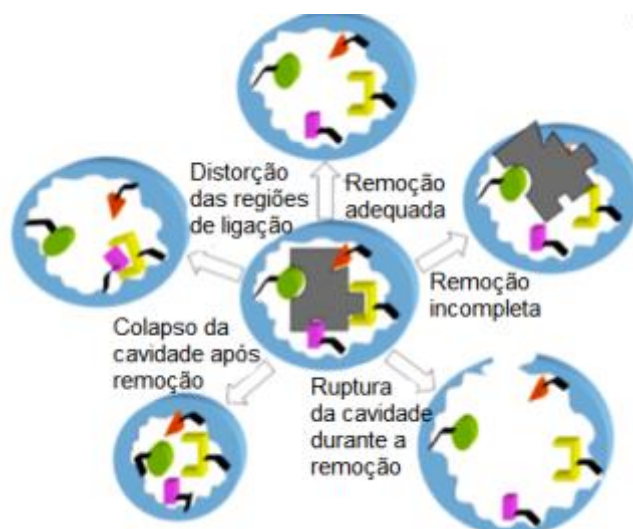
Figura 3.6 Ilustração das alterações que o MIP pode sofrer durante a remoção da partícula alvo. Adaptado de LORENZO et al. (2011).
