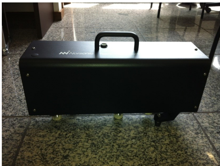
Figura 7 - Máquina geradora de ruído de impacto - Padrão ISO 140-7
