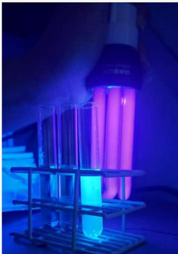
Figura 7: Observação da fluorescência da quinina, presente na água tônica (tubo da direita).
