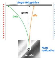
Experimento de identificação de carga de radiações (imagem sem escala; cores fantasia)
