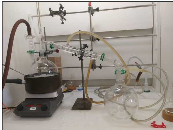
Figura 24 – Destilação do diclorometano sob atmosfera inerte de argônio.
