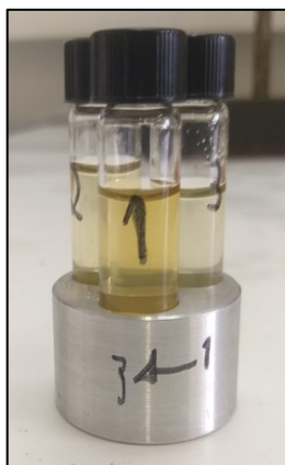
Figura 26 – frascos de reações de hidrogenação e bloco adaptador.
