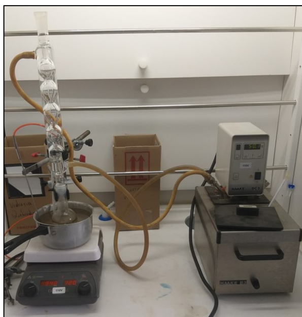
Figura 20 – Reação de transesterificação para obtenção do octanoato de octila sob refluxo.
