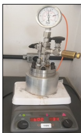
Figura 27 – Reator pressurizado sob aquecimento e agitação.
