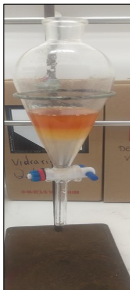
Figura 21 – Lavagem do meio reacional com solução saturada de \text{NaHCO}_3 Seguido pela separação da fase orgânica pela fase aquosa.
