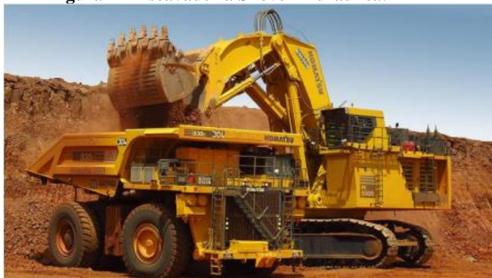
Figura 2 – Escavadeira Shovel Hidráulica.
