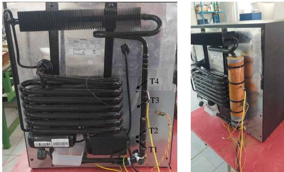
Figura 3.4 - Montagem para caracterização da fonte de energia do mini bar Dometic.
