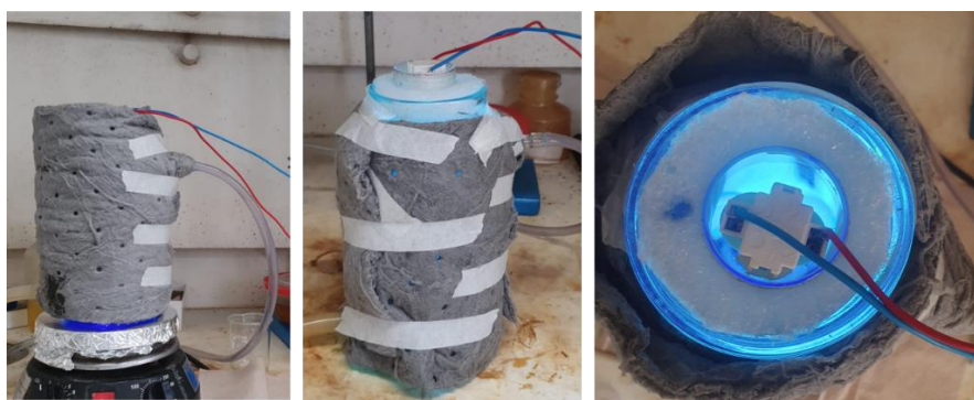
Figura 4.2 – Reator de vidro encamisado com circulação de água para resfriamento e lâmpada UVA alocada bulbo de quartzo.
