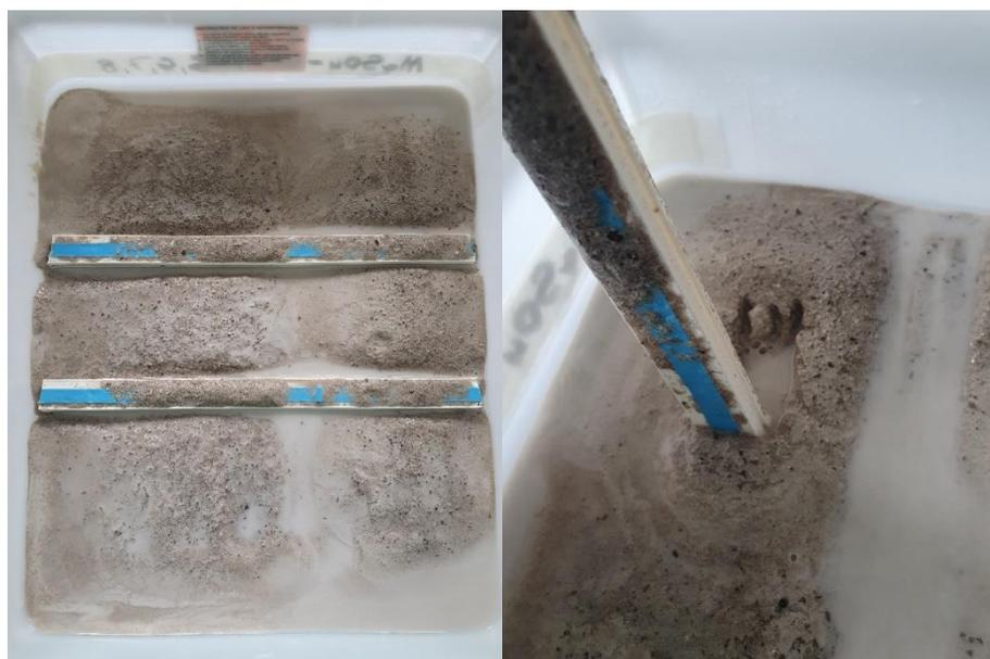
Figura 4.31 – Depósito de material no fundo do recipiente utilizado em amostras T-10-1,5 e T-10-2,5 após 20 semanas de exposição à solução de  $MgSO_4$ .
