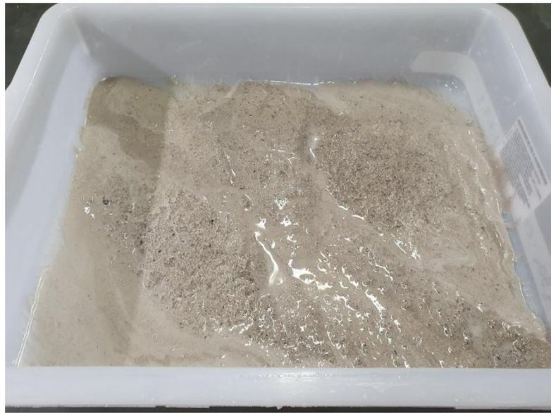
Figura 4.27 – Depósito de material no fundo do recipiente utilizado em amostras T-10 após 20 semanas de exposição à solução de  $MgSO_4$ .
