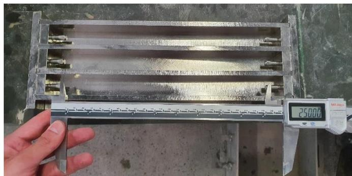
Figura 3.3 – Molde utilizado para o preparo dos CPs do Grupo A
