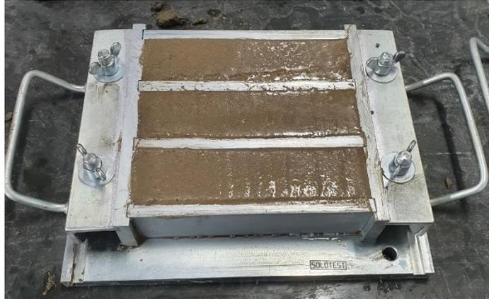
Figura 3.4 – Molde utilizado para o preparo dos CPs do Grupo B
