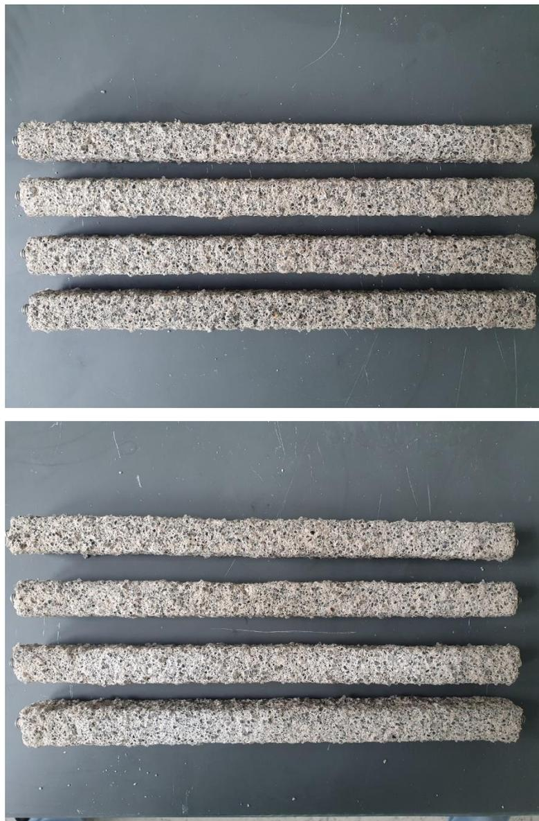
Figura 4.29 – Amostras T-10-1,5 e T-10-2,5 após 20 semanas de exposição à solução de  $MgSO_4$
