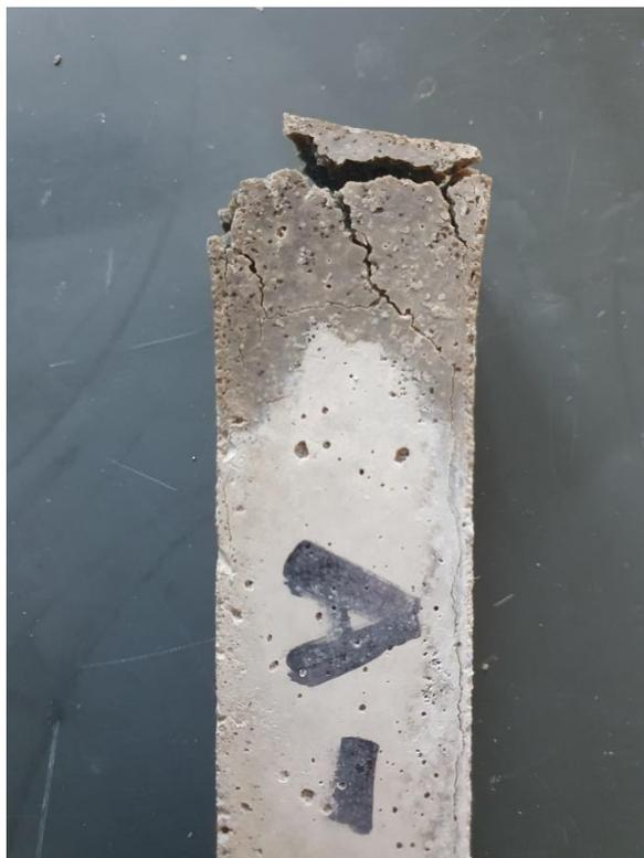
Figura 4.22 – Detalhe amostra T-REF após 20 semanas de exposição à solução de  $\text{Na}_2\text{SO}_4$ .
