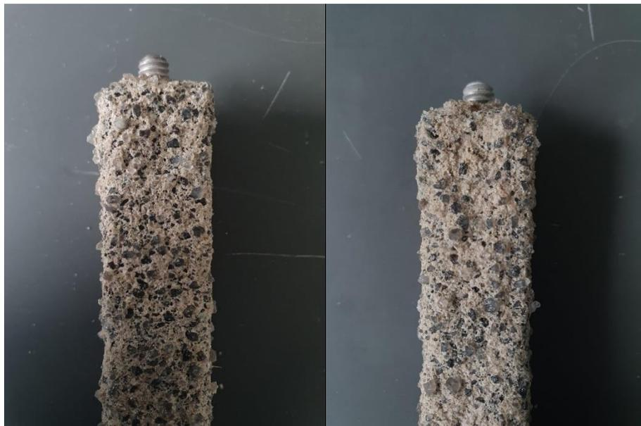
Figura 4.30 – Detalhe amostras T-10-1,5 e T-10-2,5 após 20 semanas de exposição à solução de  $MgSO_4$ .
