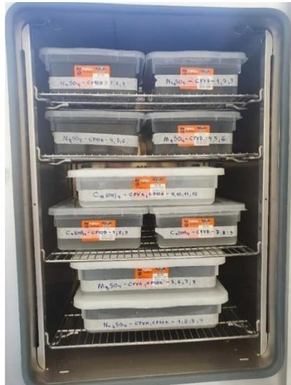
Figura 3.6 – Forno Thermo Scientific Heratherm com temperatura constante de  $40 ^\circ\text{C}$
