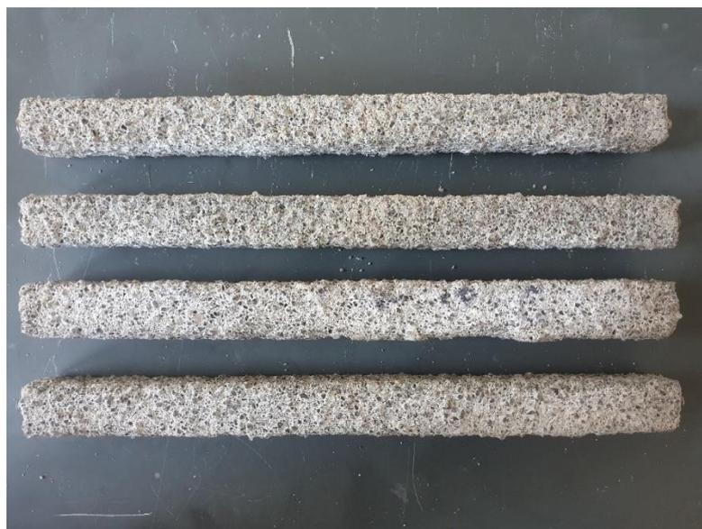
Figura 4.25 – Cimento T-10 após 20 semanas de exposição à solução de  $MgSO_4$ .
