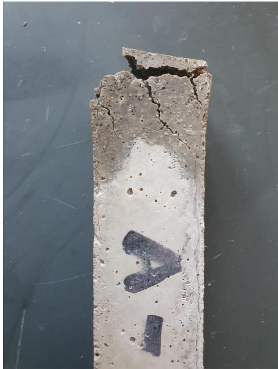
Figura 4.3 - Detalhe amostra de cimento CPV após 20 semanas de exposição à solução de  $\text{Na}_2\text{SO}_4$ .
