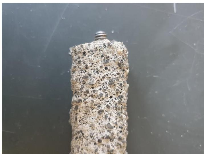
Figura 4.26 – Detalhe amostra T-10 após 20 semanas de exposição à solução de  $MgSO_4$ .
