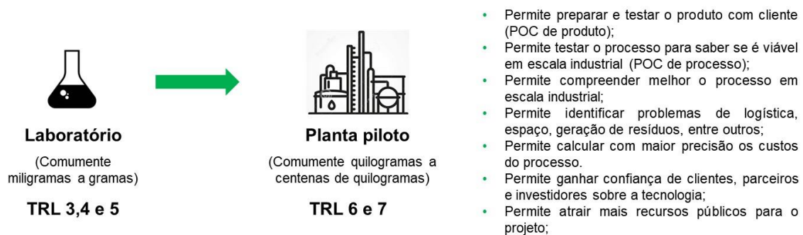
Figura 4: Etapas da Prova de Conceito realizada em laboratório e em planta piloto.
