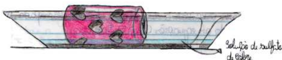
Figura 13. Corrosão da latinha de alumínio
