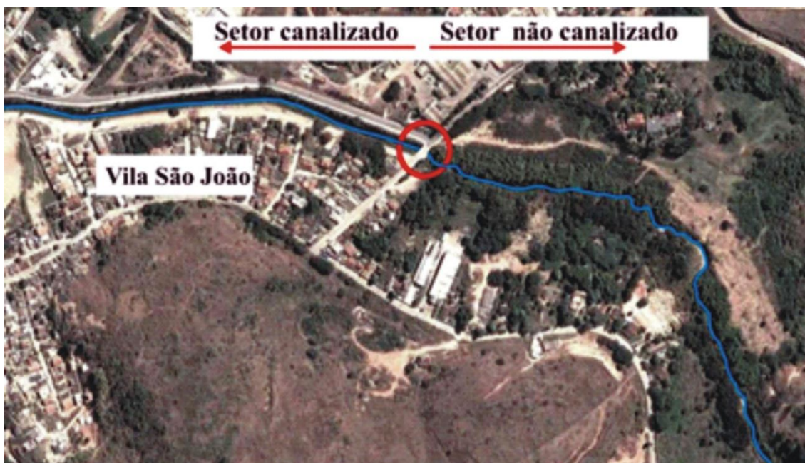
Figura 6. Extremidade jusante da canalização do Rio Todos os Santos (demarcada com o círculo vermelho). Note que após o trecho canalizado o rio adquire traçado meandrante, uma vez que este setor não sofreu intervenção.
