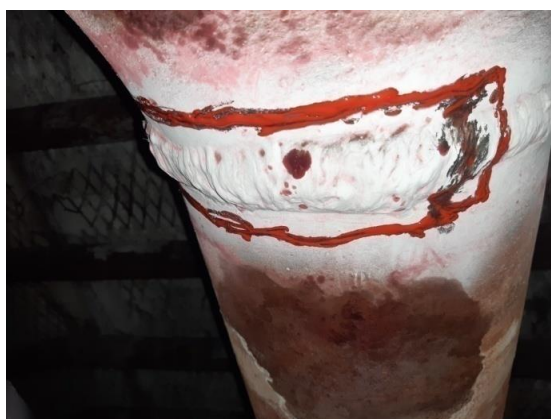
Figura 10 - Morfologia típica das descontinuidades encontradas.
