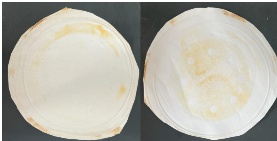
Figura 12 - Fotografia da membrana após permeação.
