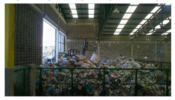
Figura 29: Uso improvisado da empilhadeira na plataforma de descarregamento
