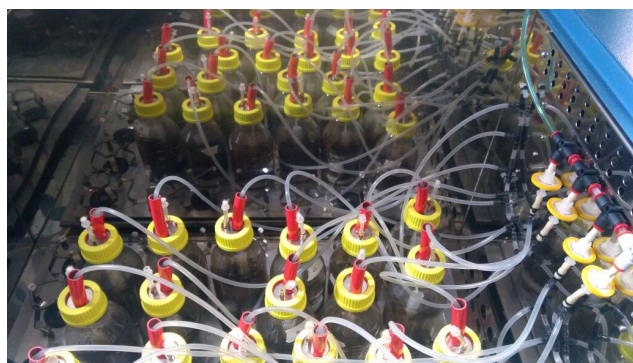
Figura 16 – Estrutura montada para a aeração dos frascos utilizados para o experimento de biorremediação do sedimento por meio de um compressor de ar.
