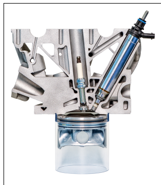
Figura 1 – Sistema de pré-câmara de combustão desenvolvido por IAV
