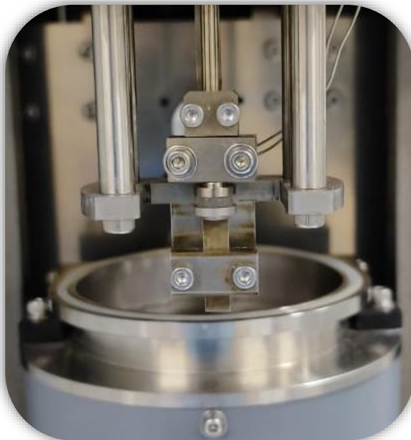
Figura 5.9 – Imagem da amostra HEDS logo antes de ser submetida ao ensaio dinâmico de compressão em PBS.
