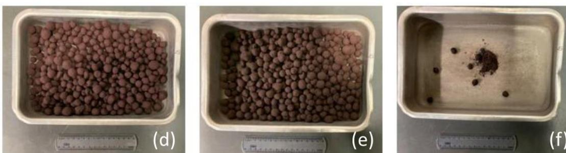
Figura 5.7: Amostra de pelotas submetida ao teste de queda (d), massa retida (e), massa menor que 10mm (f)
