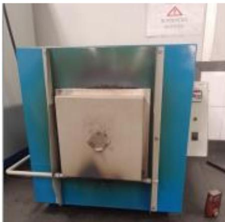
Figura 4.7: Forno tipo mufla utilizado nos ensaios
