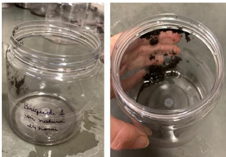
Figura 5.4: Geração de finos dos briquetes após a absorção de água.
