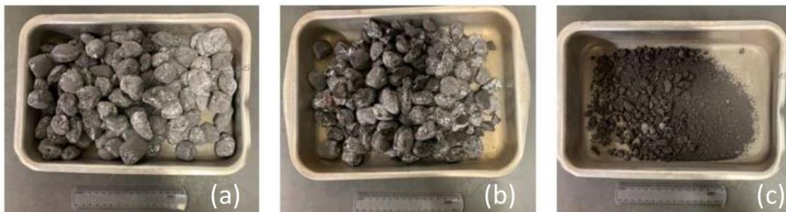
Figura 5.6: Amostra de briquetes submetida ao teste de queda (a), massa retida (b), massa menor que 10mm (c)
