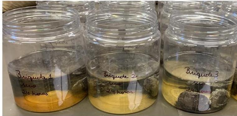
Figura 5.2: Briquetes submersos em água
