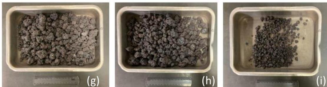
Figura 5.8: Amostra de sinter submetida ao teste de queda (g), massa retida (h), massa menor que 10mm (i)
