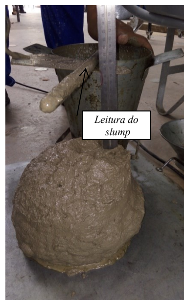
Passo 5: Medição do slump
