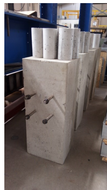
Passo 8 : Desforma dos modelos (bloco e CP's)
