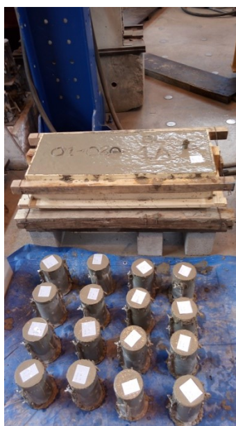
Passo 7: Moldagem dos CP's, identificação dos modelos e cura ao ar.
