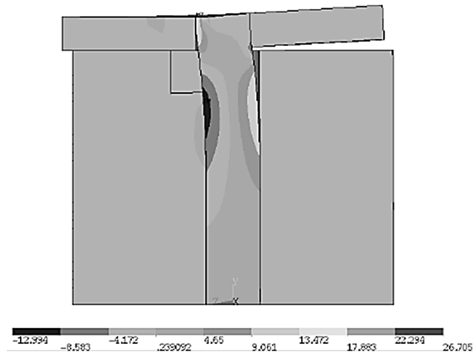
Figura 2.16 – Mapa de tensões \sigma_y (MPa) e deslocamentos relativos no modelo global (Muniz, 2002).
