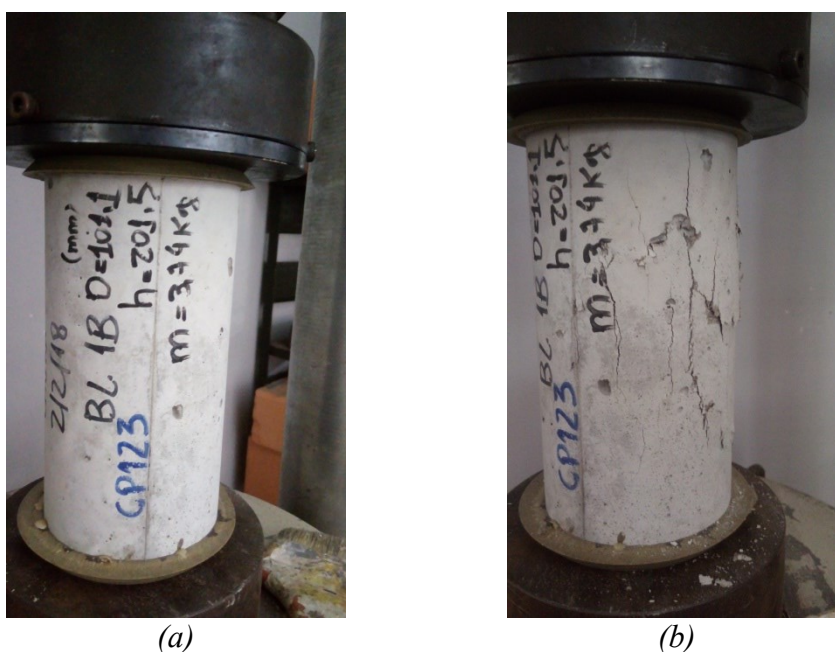
Figura A.12 – Posicionamento do CP (10x20) na prensa antes (a) e depois (b) do ensaio à compressão.
